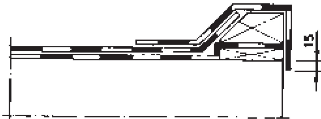
Bild 1. Saneringsarbete, takskägg med upphöjd kant, enkelt tätskikt.
