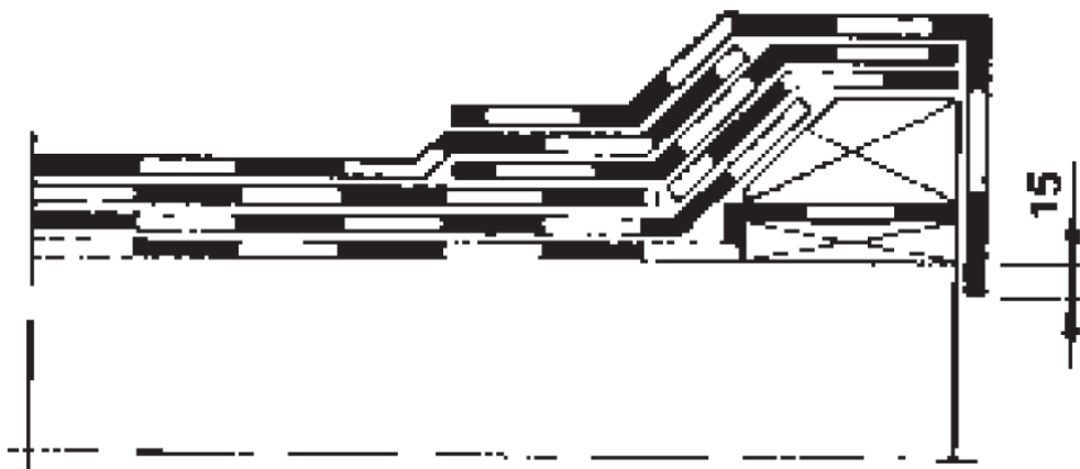
Bild 3. Saneringsarbete, upphöjd kant, tredubbelt tätskikt.
