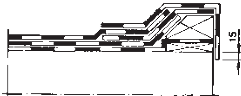
Bild 2. Saneringsarbete, takskägg med upphöjd kant, dubbelt tätskikt.
