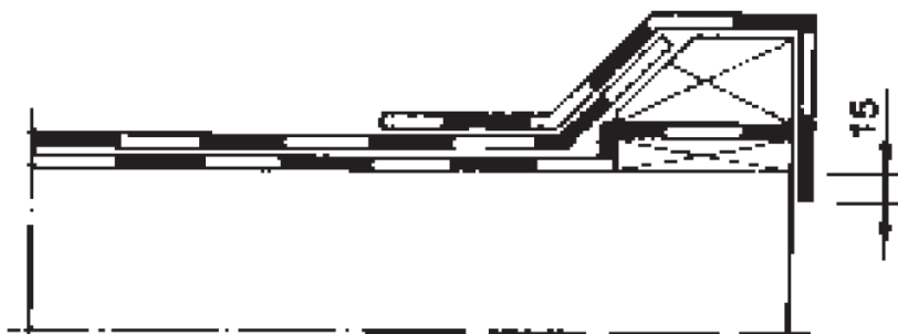
Bild 1. Saneringsarbete, takskägg med upphöjd kant, enkelt tätskikt.
