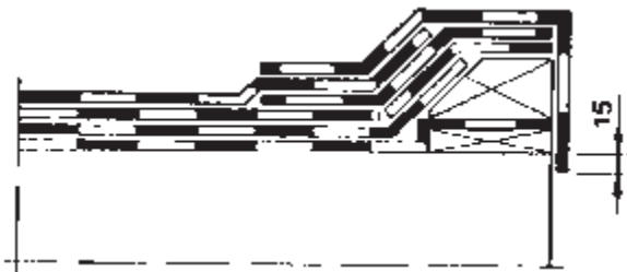
Kuva 3. Saneeraustyö, korotettu räystäs, 3-kermikate.
