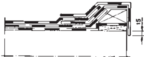
Kuva 2. Saneeraustyö, korotettu räystäs, 2-kermikate.
