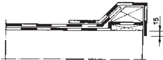
Kuva 1. Saneeraustyö, korotettu räystäs, 1-kermikate.
