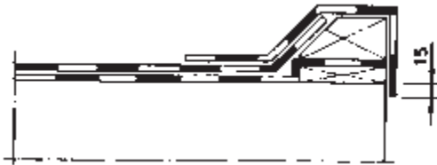
Kuva 1. Saneeraustyö, korotettu räystääs, 1-kermikate.
