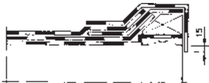
Kuva 2. Saneeraustyö, korotettu räystäs, 2-kermikate.
