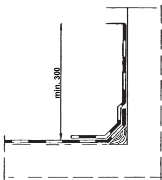
Bild 7. Upp mot vägg, enkelt täktskikt.
