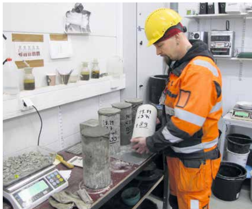
Elementtitehtaan laboratorioissa työskentelevä Tuomas Tihinen tutkii lieriön sijoitettujen betonilaatujen ominaisuuksia.
