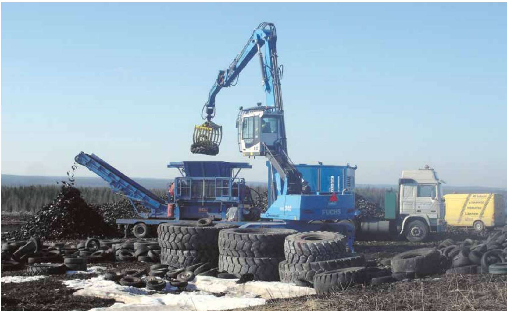
Käytetyt renkaat leikataan jatkokäyttöä varten. Kuva: Hannu Aurinko
