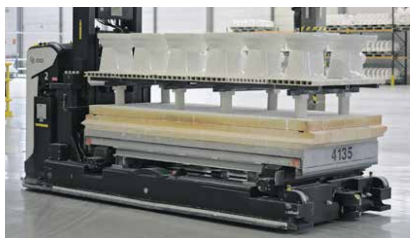
Robottitrukit ajelevat turvallisesti pönttöjä uunilta viimeistelyyn.
