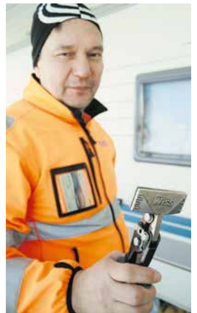
Jukka Riipin listapihdit, joilla tehdään pieniä kanttauksia.
