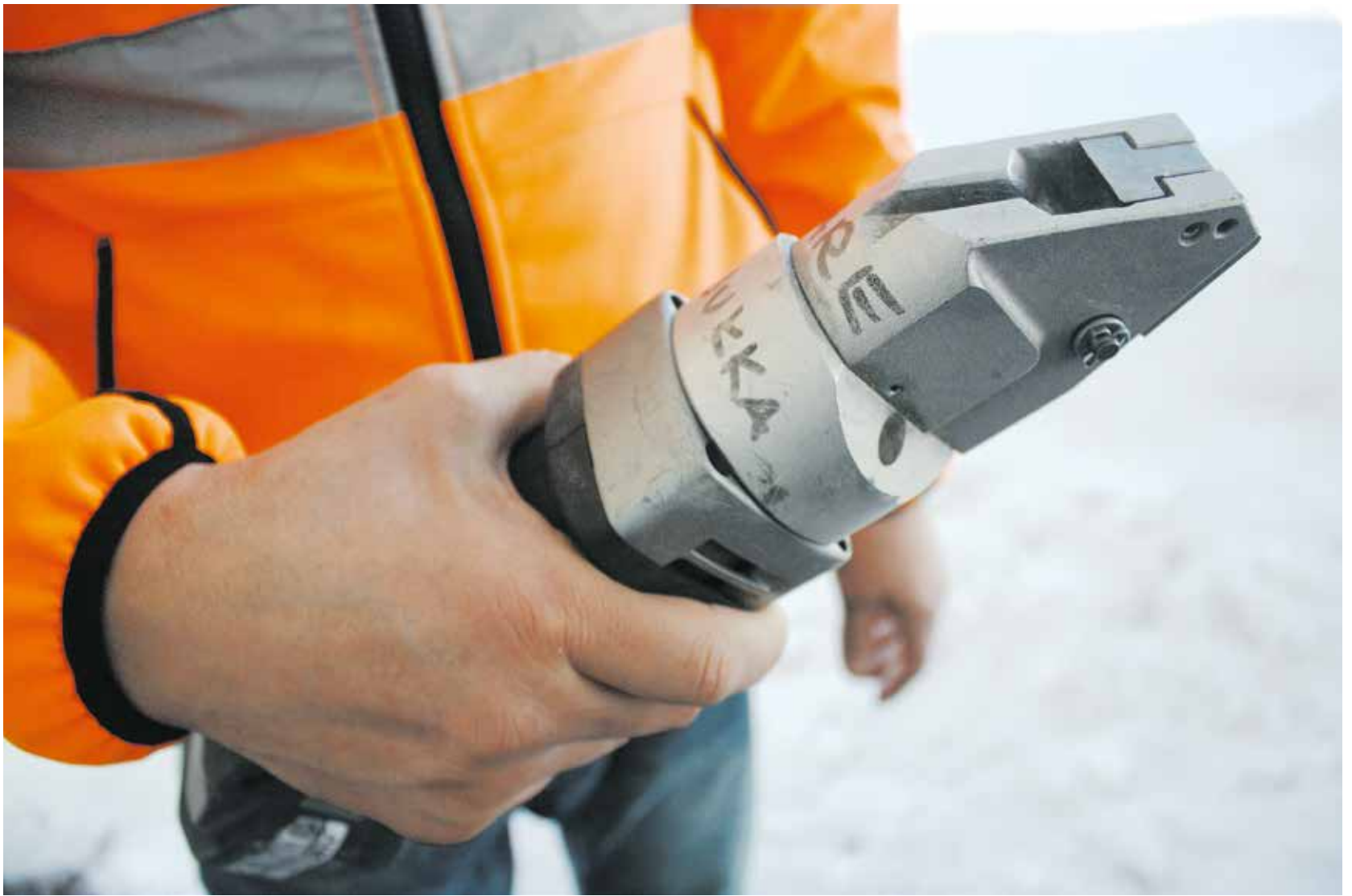
Kanavaleikkuri, jolla leikataan putket sopiviksi pätkiksi.
