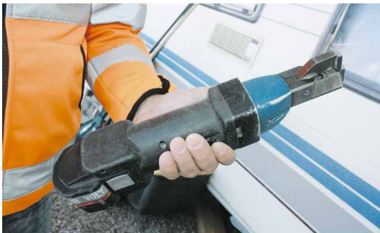
Tötsärillä lyhennetään putket katto- tai seinäpinnan tasolle.
