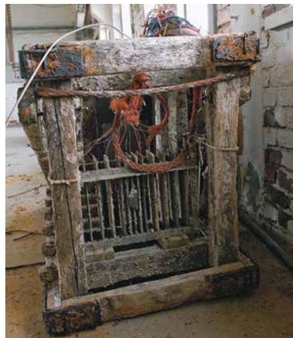
▲ Metallinäytteet kiinnitetään puisiin telineisiin, jotka on jätetty merivesialtaisiin vuosiksi.
