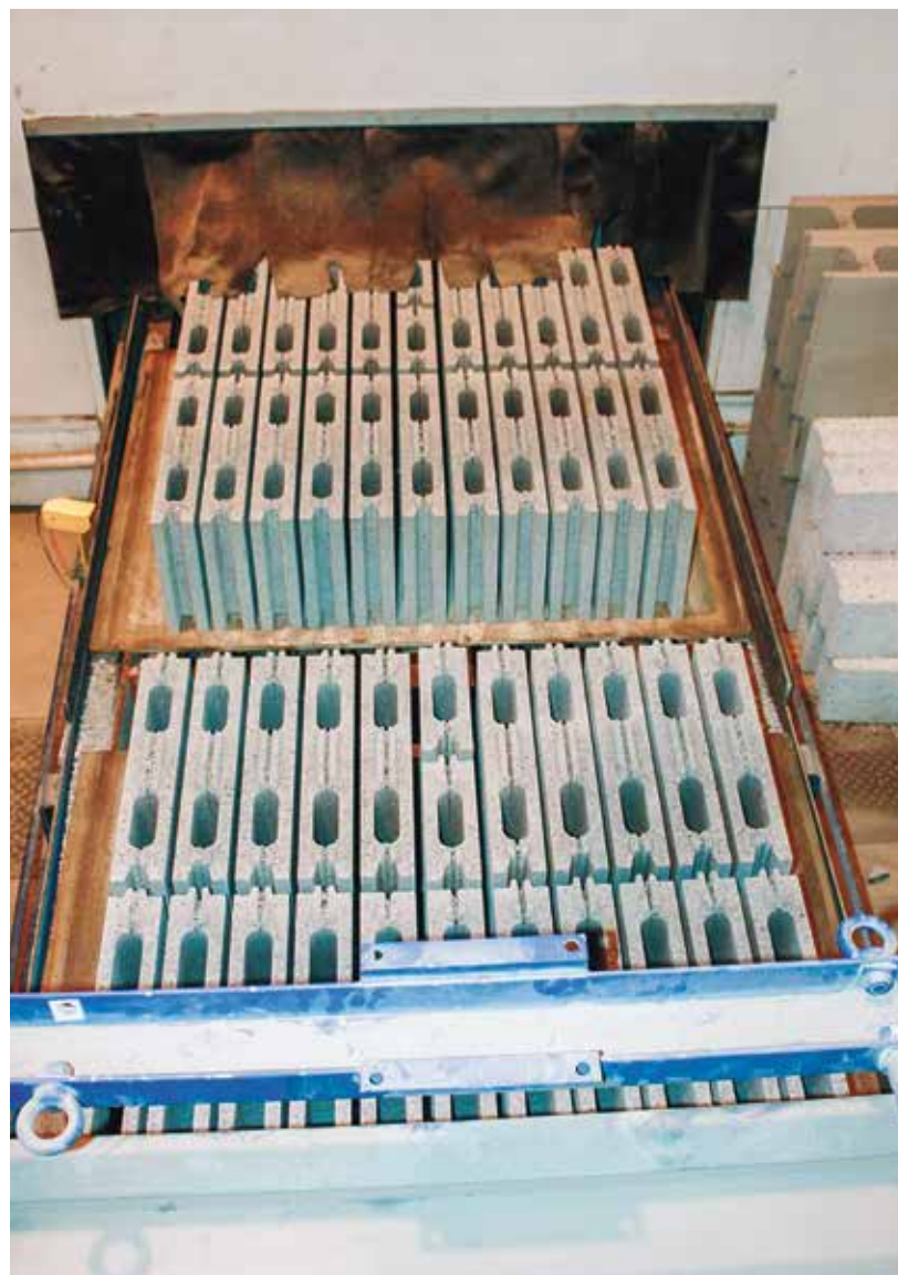
Valmiit väliseinä-harkot siirtyvät kohti pakkausta. Leca-harkkotehtaalla Oitissa työskentelee vähintään 2 henkilöä vuorossa, yleensä 3.
