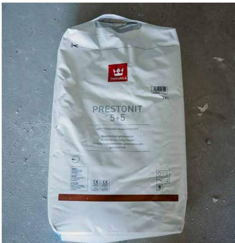
Hartelan työmaalla käytetään Tikkurilan valmisruiskutasoitetta.
