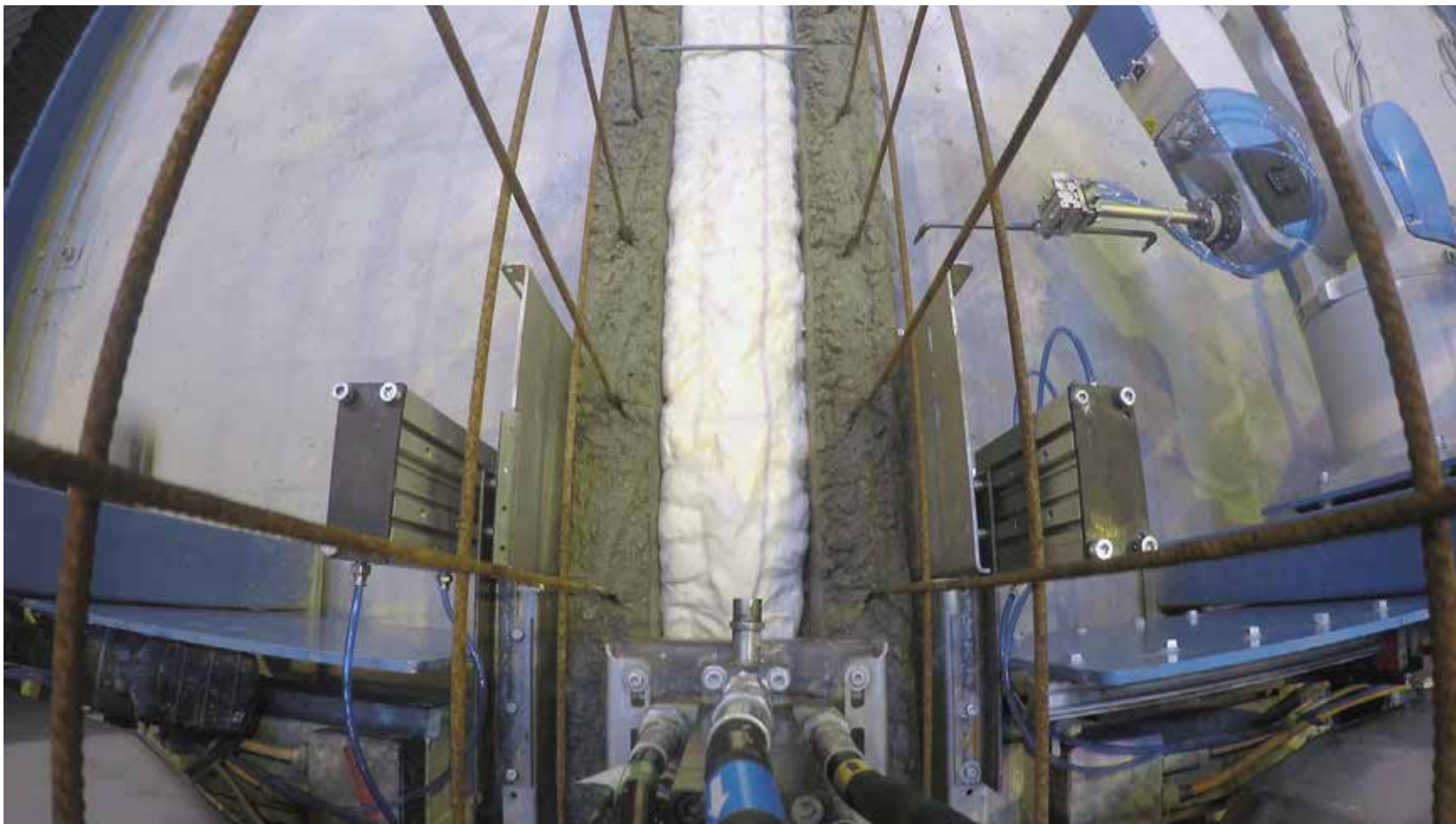
Elementtitulostimessa 2 pursotinta kerrosta sementtiä. Väliin tulee nestemäinen polyuretaani, joka kovettuu eristeeksi.
