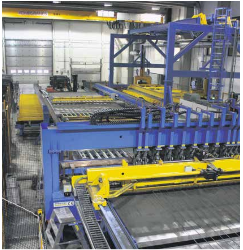
Erikoisverkon hitsauskone oli vuonna 2014 monen miljoonan investointi. Elementtiteollisuuden tuoteryhmäpäällikkö Saku Ailanen uumoilee, että mittatilausverkko yleistyy vakioverkkoon verrattuna lähivuosina.
